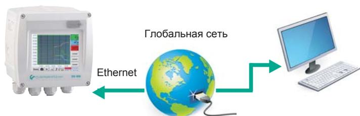
Опция «Веб-сервер» позволяет подключить DS 400 без помощи дополнительного ПО через любой веб-браузер (напр. Mozilla Firefox®, Microsoft Internet Explorer®). Доступ также может быть осуществлен через глобальную сеть. Веб-сервер в браузере выводит измеряемые значения всех датчиков, а также состояние сигнальных реле и состояние даталоггера.
