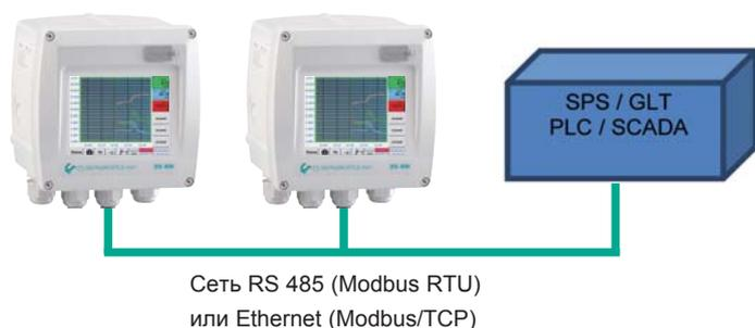
Оснащенный опцией «Ethernet/RS 485-интерфейс» DS 400 может быть подключен к промышленной сети на предприятии пользователя (напр. PLC, BMS, SCADA). Результаты измерений всех датчиков могут быть переданы через протокол Modbus. Подробное описание протокола поставляется вместе с каждым прибором DS 400. При использовании Ethernet-интерфейса, можно закрепить за DS 400 IP-адрес. Также адрес DS 400 может быть назначен DHCP-сервером.
